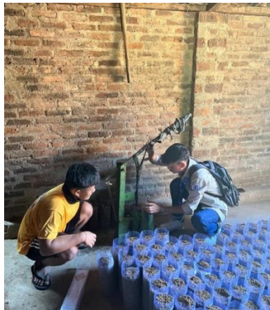
Gambar 2. Pengepresan Media Tanam dalam Baglog
