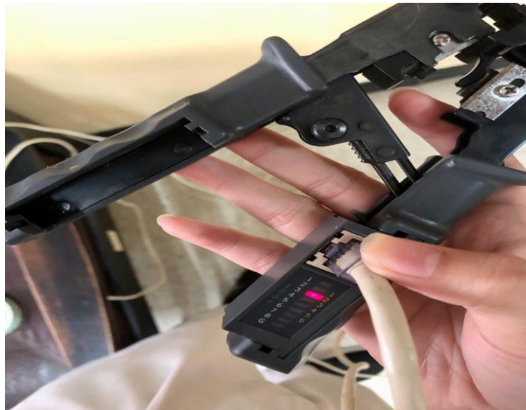
Gambar 4. Krimping Kabel Berhasil
