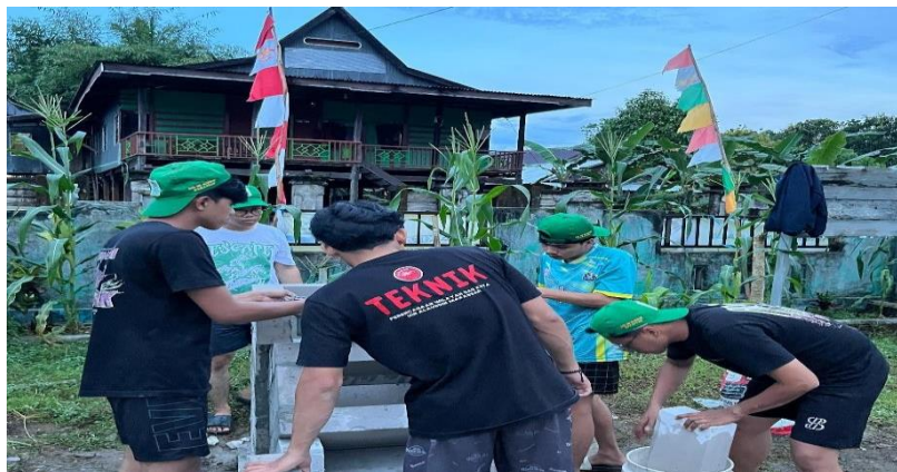
Gambar 1. Proses Pembuatan Rocket Stove Menggunakan Material Bata Ringan dan Semen di Kelurahan Mattappawalie
